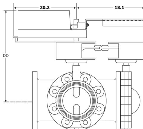
РАЗМЕРЫ КЛАПАНОВ С ТТ & ТМ ПРИВОДАМИ
