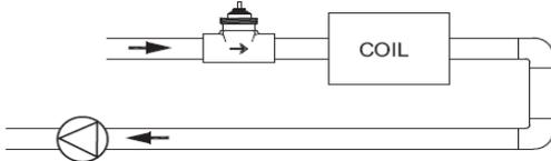
**Установка клапана после оборудования**
