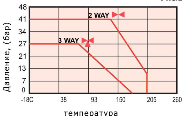
NEPTRONIC предлагает линейку двухходовых промышленных шаровых клапанов размером от 1/2 до 3 дюймов, с максимальным давлением для воды до 41 бар и трехходовых - для максимального давления до 27 бар. Небольшие размеры клапанов позволяют устанавливать их в ограниченном пространстве и труднодоступных местах.
