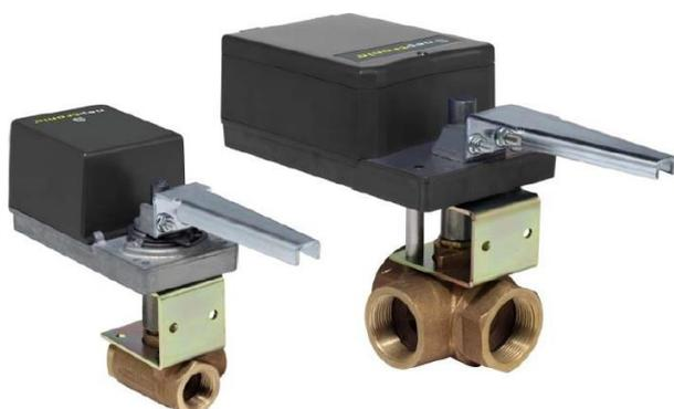
**2-х и 3-х ходовые регулирующие, смесительные, отсечные и распределительные шаровые клапаны** для управления гидравлическими системами с горячей и холодной водой с содержанием гликоля до 50%, воздуха, а также для регулирования подачи пара низкого давления. Они могут управлять системами аналогично седельным клапанам по значительно более низкой стоимости.
