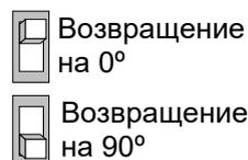
**УСТАНОВКА ДИАПАЗОНА:** для установки желаемого диапазона вращения установить ограничительный винт в требуемое положение.
