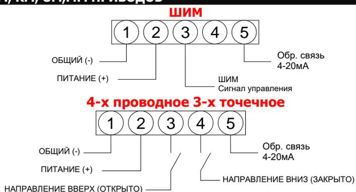
**Специально для приводов с импульсным управлением и обратной связью.** В данном случае привод чувствителен к вызванным электрическим наводкам от других источников. Чтобы предотвратить помехи, необходимо применение резисторов, поставляемых в комплекте с приводами.
